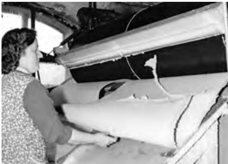
Odvodňovací stroj na dřevovinu r. 1967
